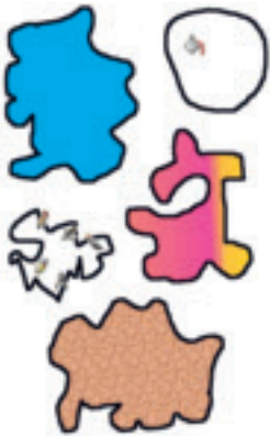
Bij Solid modeling heeft de ontwerper geen controle over de binnenkant. Alleen de buitencontour van een object wordt gedetailleerd beschreven, de binnenkant wordt blindelings volgestort met materiaal.
