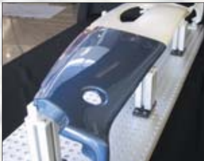
Dashboard vervaardigd met FDM.
