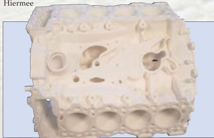
Met Selective Laser Sintering kunnen complexe delen worden gebouwd, zoals deze motorbehuizing. (Foto: Materialise)
