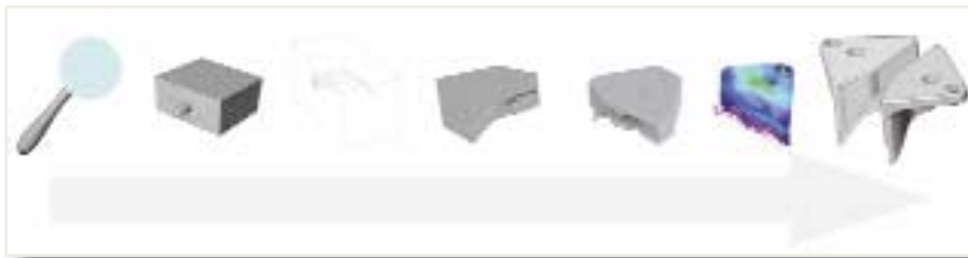
Automatisierte Fertigung von produktindividuellen Greiferbacken – gewichts- und belastungsoptimiert. Bilder: Fraunhofer IPA
