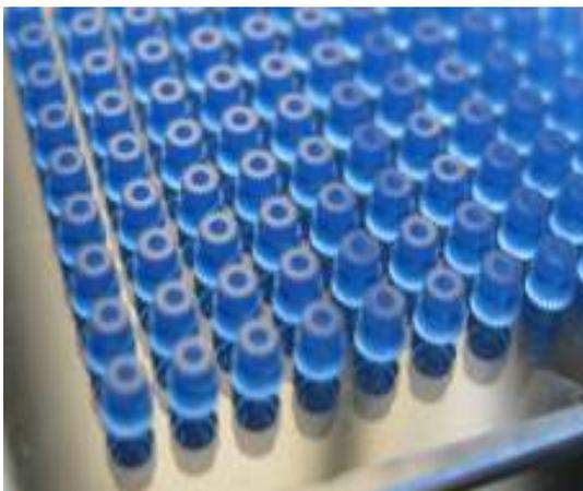
**FIG. 3: BATCH WITH RMPD<sup>®</sup> GEARS, MODULE 0,06; DIAMETER 1,2MM AND 0,86MM**
